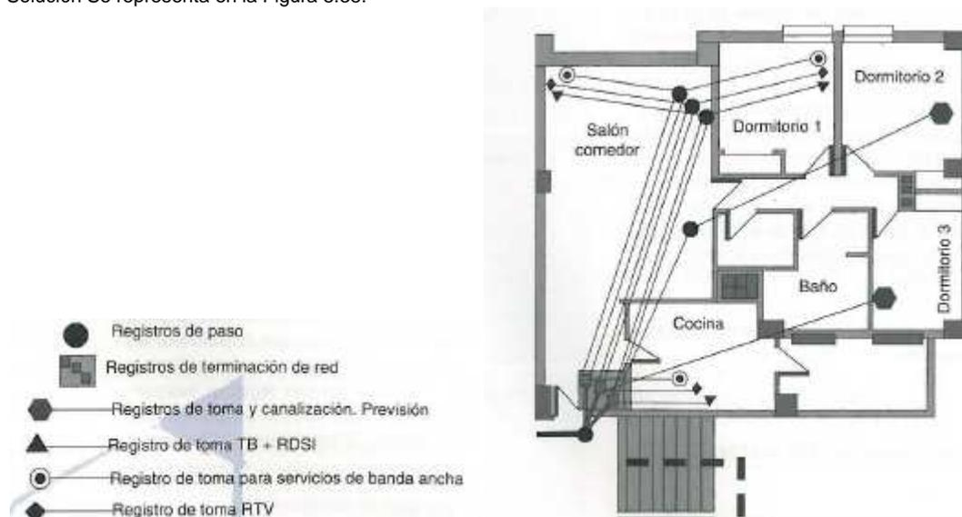
**Fig. 8.38. Ejemplo de canalización para telecomunicaciones**
